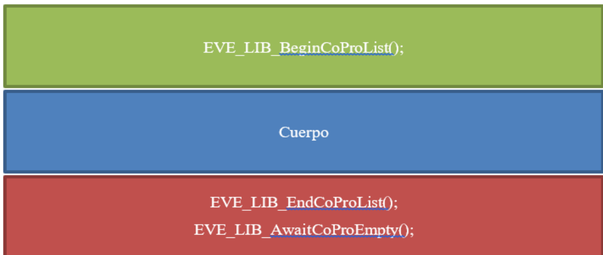
Figure 16. Esquema de sintaxis de comandos de pantalla
