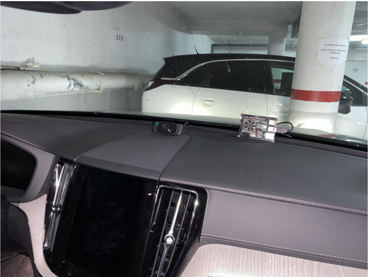
Figura 21. Montaje de webcam y Raspberry Pi en el vehículo
