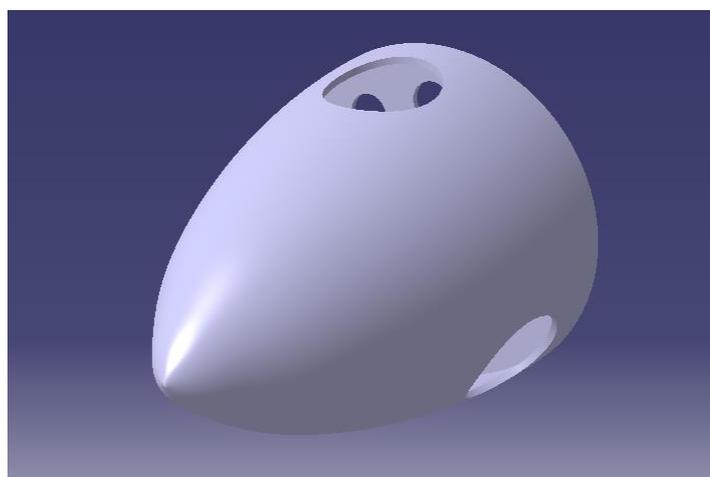
Figura 4.38: Modelado del cono de hélice del Hawker Hurricane.
