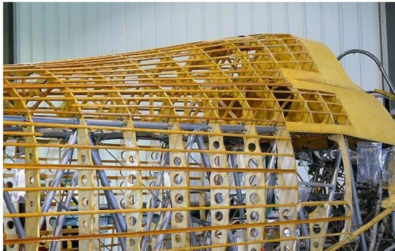
Figura 4.71: Proceso de restauración de un Hawker Hurricane donde se muestra parte de la estructura interna del fuselaje. [5]
