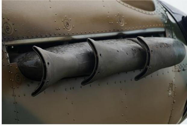
Figura 4.61: Sistema de escape real de un Hawker Hurricane [6].
