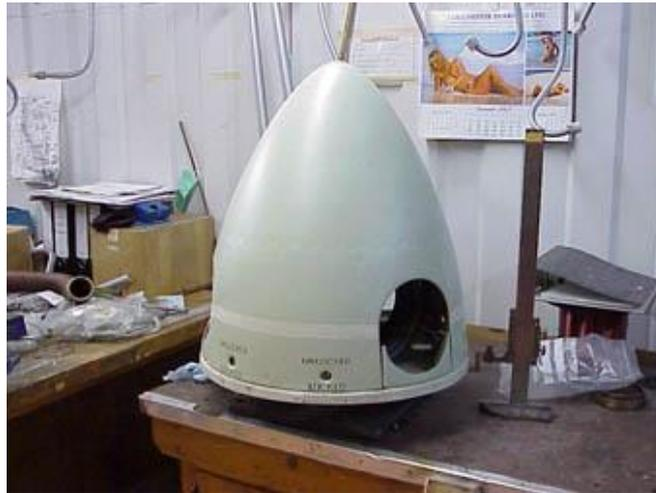
Figura 4.37: Fotografía real del cono de la hélice del Hawker Hurricane. [5]
