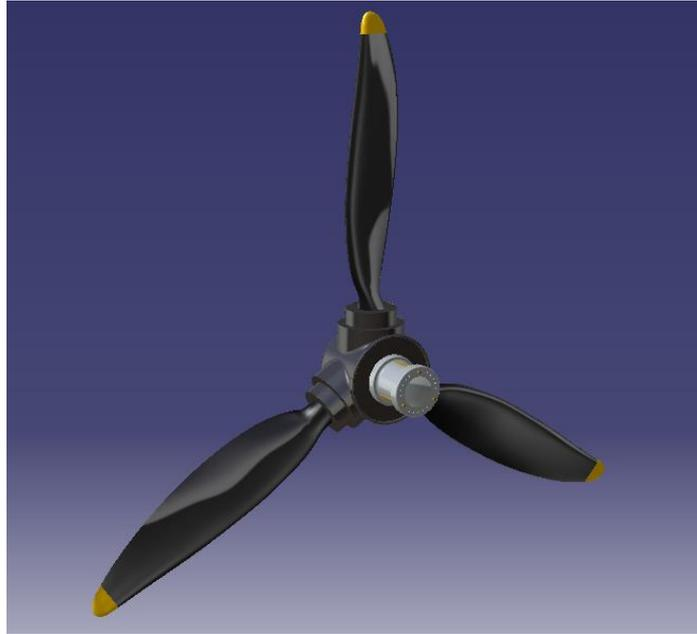
Figura 4.49: Renderizado final de las palas y el encastre.
