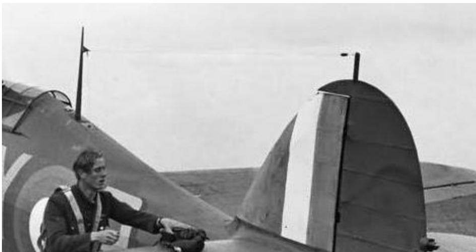
Figura 4.65: Fotografía histórica de la parte trasera del Hawker Hurricane con la antena T.R.9D [22].
