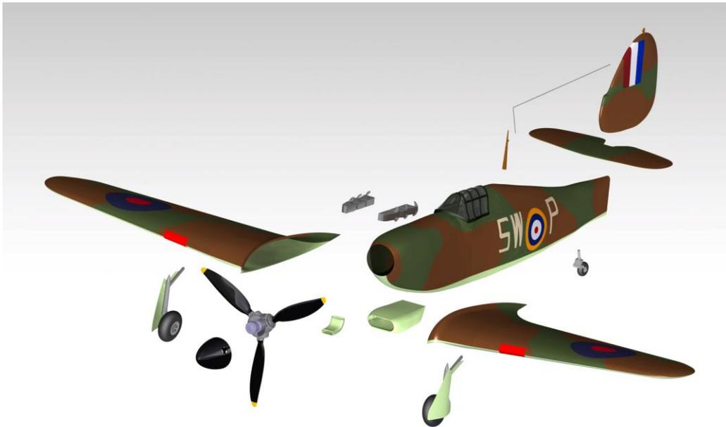
Figura 4.1: Parte exterior del Hawker Hurricane separada en varias piezas.
