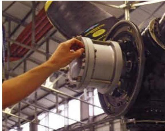
Figura 4.39: Encastre y cilindro del cambio de paso de las palas [4].
