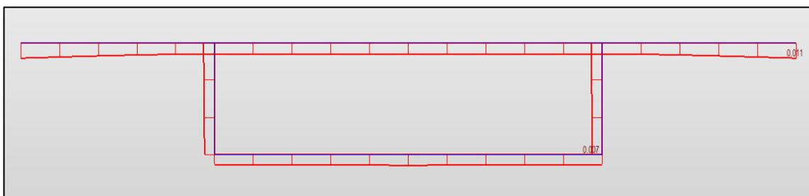
Figura 3-42. Deformada de la sección 1-1 en el modelo con esviaje 0°
