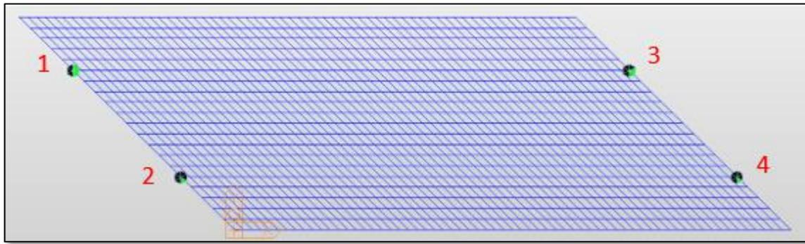
Figura 2-4. Condiciones de contorno en los apoyos. Vista en planta del modelo de Midas civil
