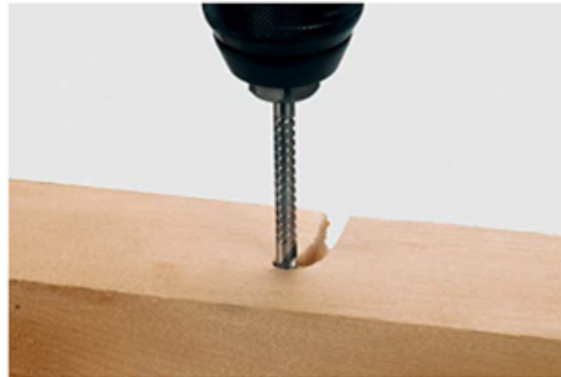
Figura 4.27 Realización de ranura en madera con fresa lateral [4].
