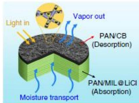
Figura 43 Funcionamiento de la doble capa biomimética [43]
