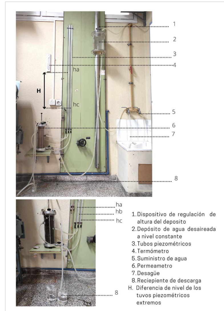
Figura.27: Componentes del equipo del ensayo de permeabilidad. Elaboración propia.
