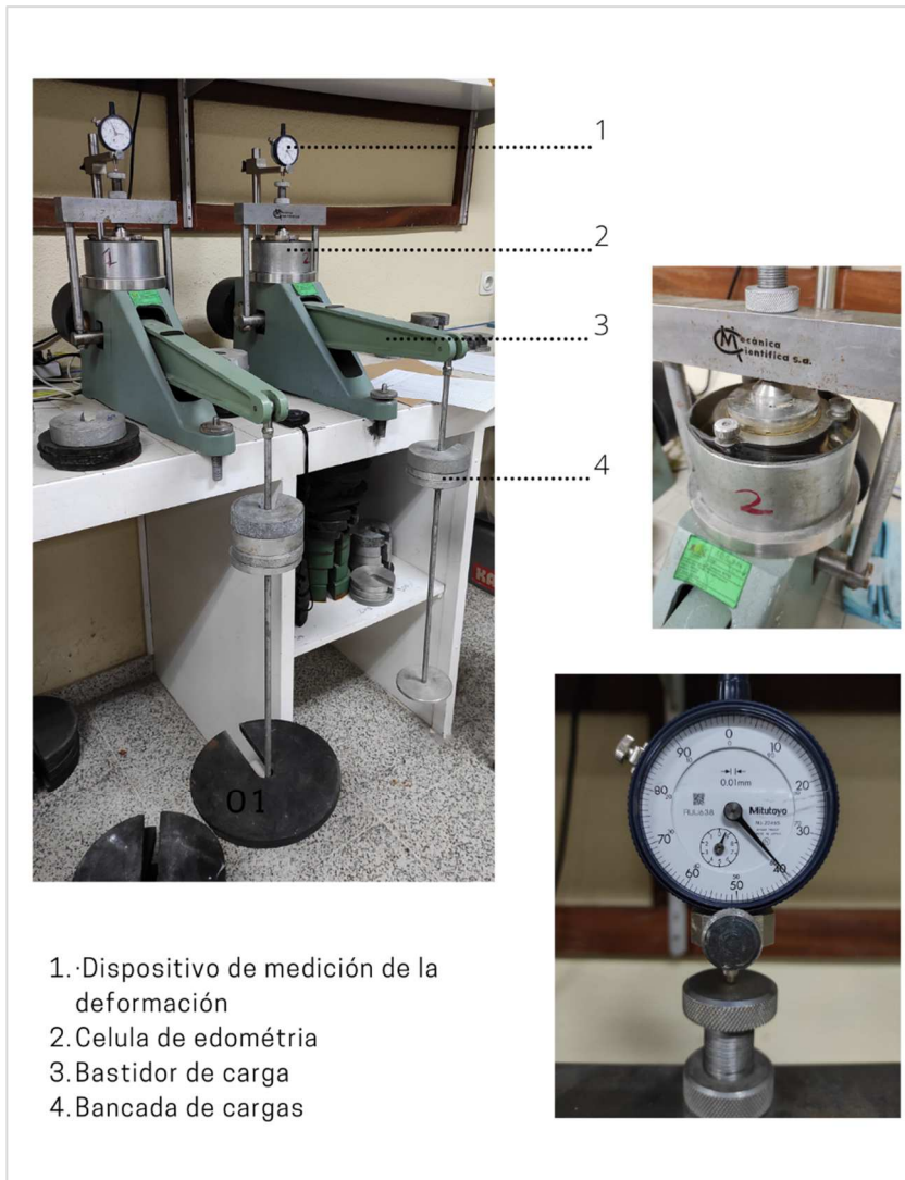
Figura.13: Componentes que forman el equipo de edometría. Elaboración propia.
