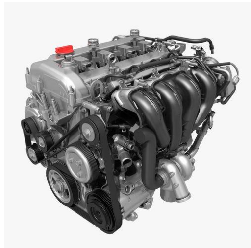
Ilustración 6.4: Motor de combustión interna de cuatro tiempos adaptado para automóvil [88]
