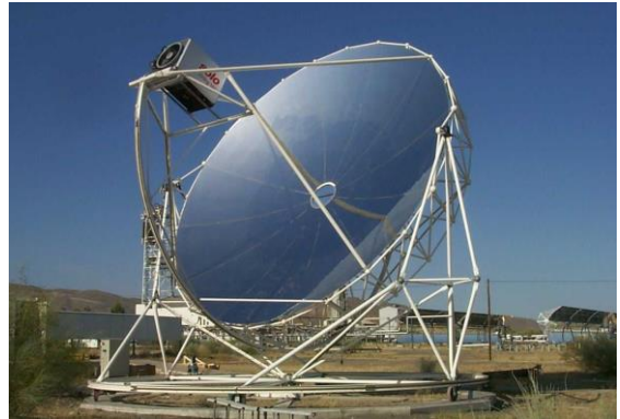
Ilustración 6.2: Motor Stirling solar en la Plataforma Solar de Almería (España) [82]
