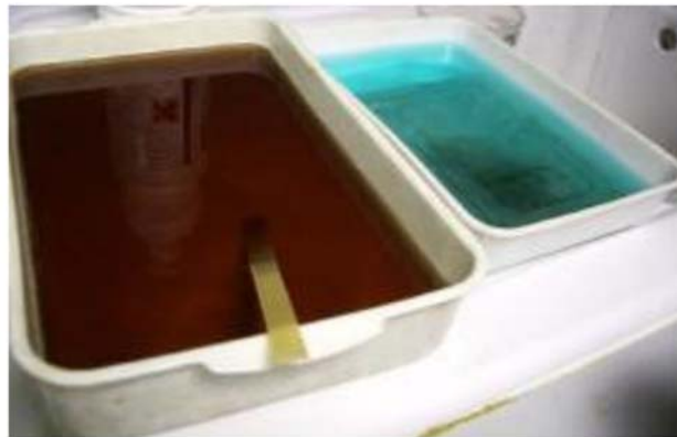
Ilustración 30. Líquido revelador (izquierda) y líquido atacante (derecha).
