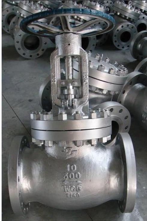
Ilustración 26. Válvula de globo
