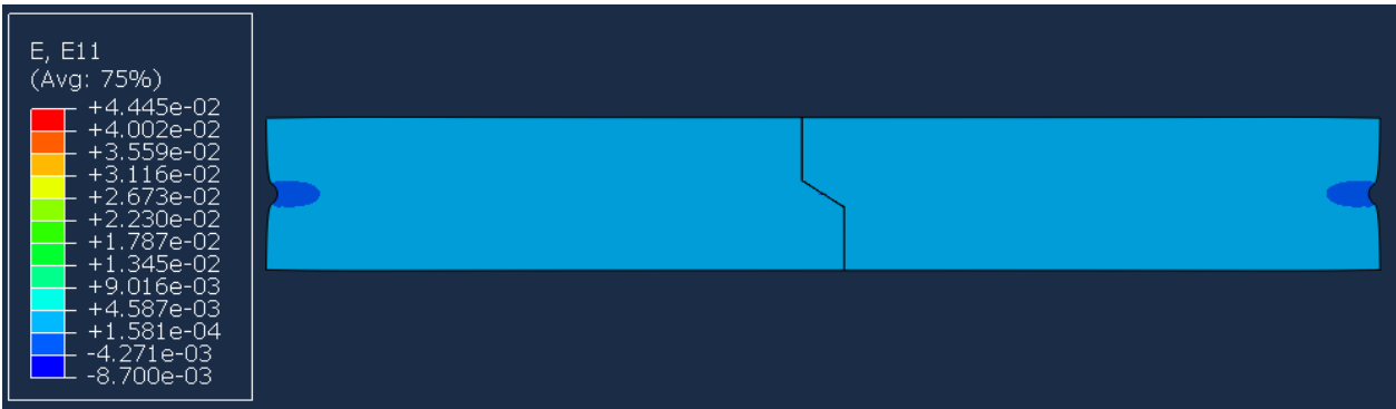
Figura 4.74. Deformación longitudinal E_{xx} del Modelo 2.T para un ángulo de la grieta de 45^\circ
