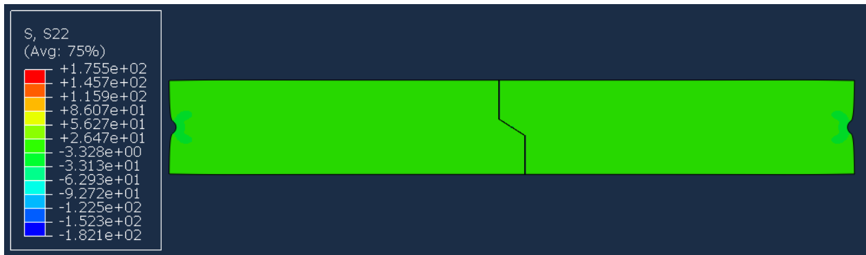
Figura 4.68. Mapa de tensiones transversales \sigma_{yy} (MPa) sobre sólido deformado para Submodelo 2.T para un ángulo \alpha de 45^\circ . Vista general
