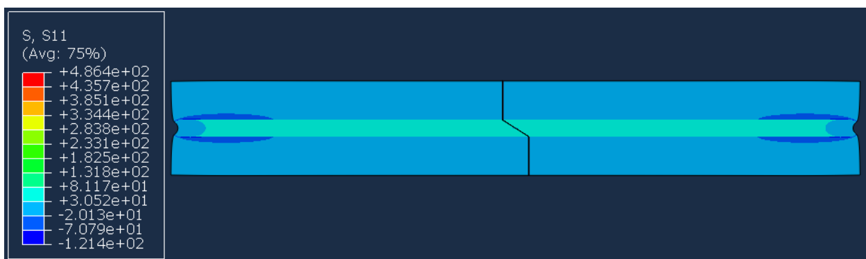
Figura 4.65. Mapa de tensiones longitudinales \sigma_{xx} (MPa) sobre sólido deformado para Submodelo 2.T para un ángulo \alpha de 45^\circ . Vista general
