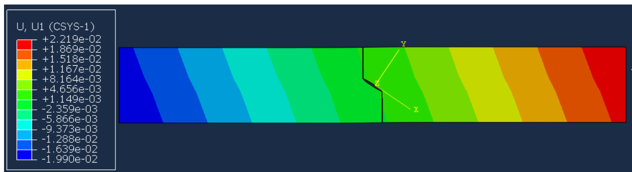
Figura 4.44. Mapa de desplazamientos tangenciales u_r (mm) sobre sólido deformado para SubModelo 5.019.45B. Vista general
