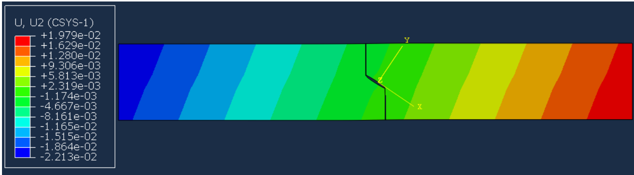
Figura 4.46. Mapa de desplazamientos normales u_n (mm) sobre sólido deformado para SubModelo 5.019.45B. Vista general
