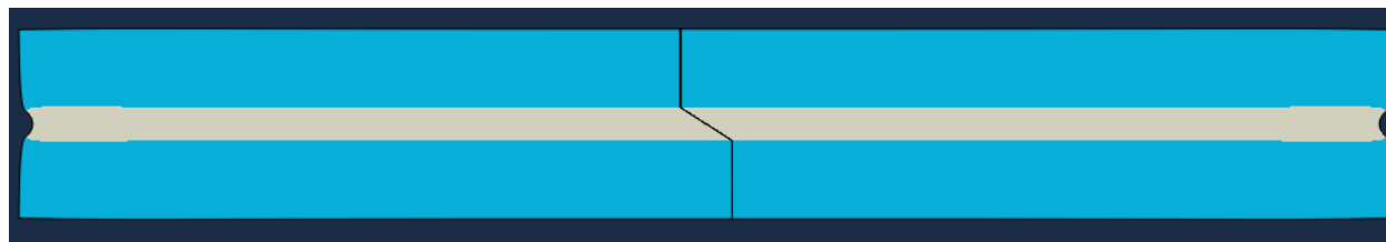
Figura 4.76. Deformada del Submodelo 3.T para una longitud de grieta de 0,02 mm
