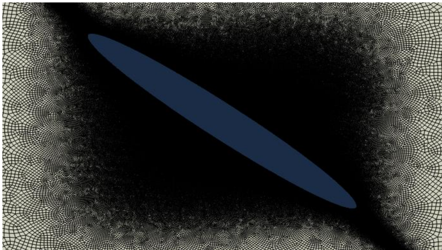
Figura 4.28. Deformada del Modelo 3 para una longitud de grieta b de 0,16 mm. Vista de detalle de la grieta
