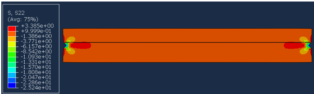
Figura 4.58. Mapa de tensiones transversales \sigma_{yy} (MPa) sobre sólido deformado para Submodelo 1.T para una longitud de grieta a de 0,625 mm. Vista general
