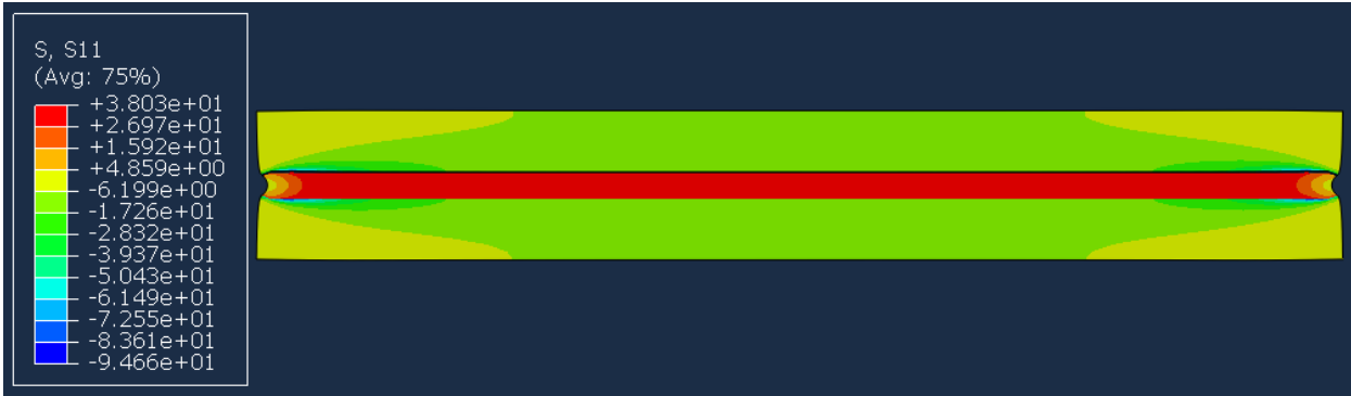
Figura 4.57. Mapa de tensiones longitudinales \sigma_{xx} (MPa) sobre sólido deformado para Submodelo 1.T para una longitud de grieta a de 0,625 mm. Vista general
