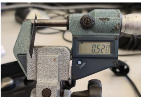
Figura 4-38. Micrómetro usado para medir el espesor de las probetas
