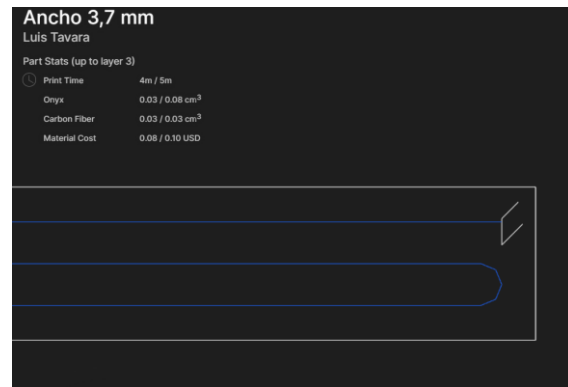
Figura 4-40. Visión interna de la probeta con un ancho de 3,7 mm de ancho
