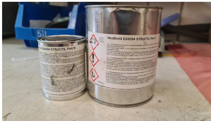
Figura 5-16. Adhesivo bicomponente usado para pegar los tacos a las probetas
