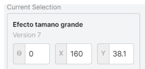
Figura 4-32. Parámetros para el posicionamiento de la pieza dentro de la cama de impresión
