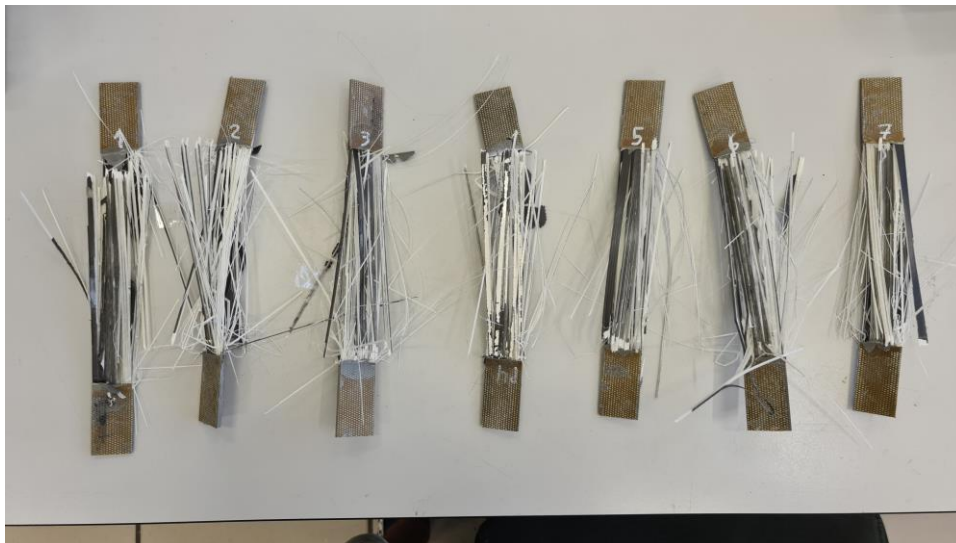
Figura 5-49. Probetas de FV grandes una vez ensayadas
