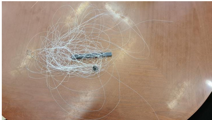
Figura 6-1. Fallo de la impresora al separarse el cabezal el tubo del cabezal de extrusión.
