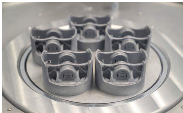
Figura 2-10: Pistones para el Porsche 911 GT2 RS fabricados con tecnología de Fabricación Aditiva [13]
