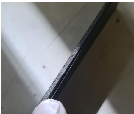
Figura 5-5. Delaminación parcial de una probeta de fibra de carbono grande vista desde el lateral
