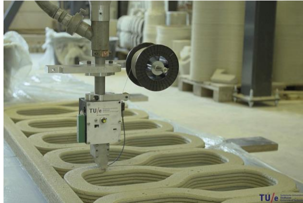
Figura 2-13. Impresión 3D de un muro en la universidad de Eidndhoven [5]
