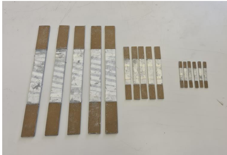
Figura 5-18. Probetas de fibra de carbono con los tacos ya pegados
