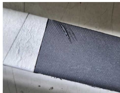
Figura 5-4. Delaminación parcial de una probeta de fibra de carbono grande vista desde arriba
