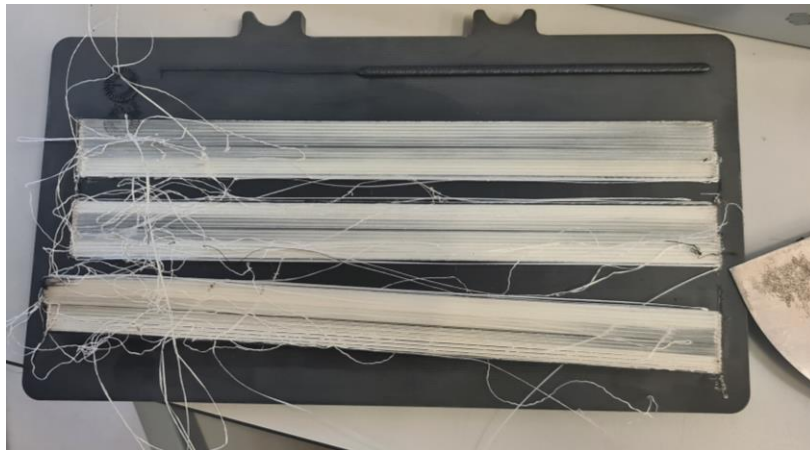
Figura 5-9. Fallo de impresión durante la impresión de probetas de vidrio de gran tamaño
