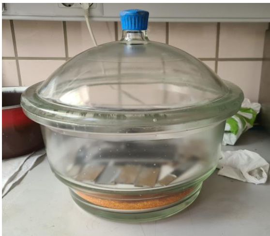
Figura 5-6. Almacenamiento de las probetas en una campana de secado
