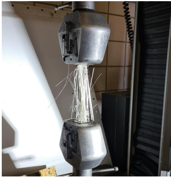
Figura 5-48. Ensayo de tracción de una probeta grande de FV
