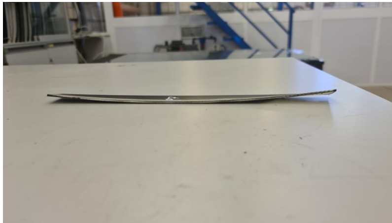
Figura 5-11. Deformaciones en la probeta nº 7 de fibra de vidrio grande
