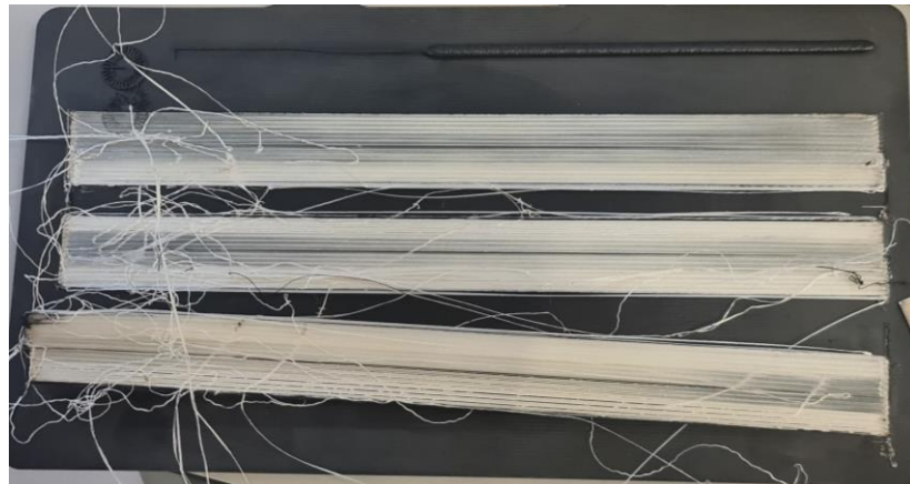
Figura 6-5. Error grave de impresión generado por un efecto dominó
