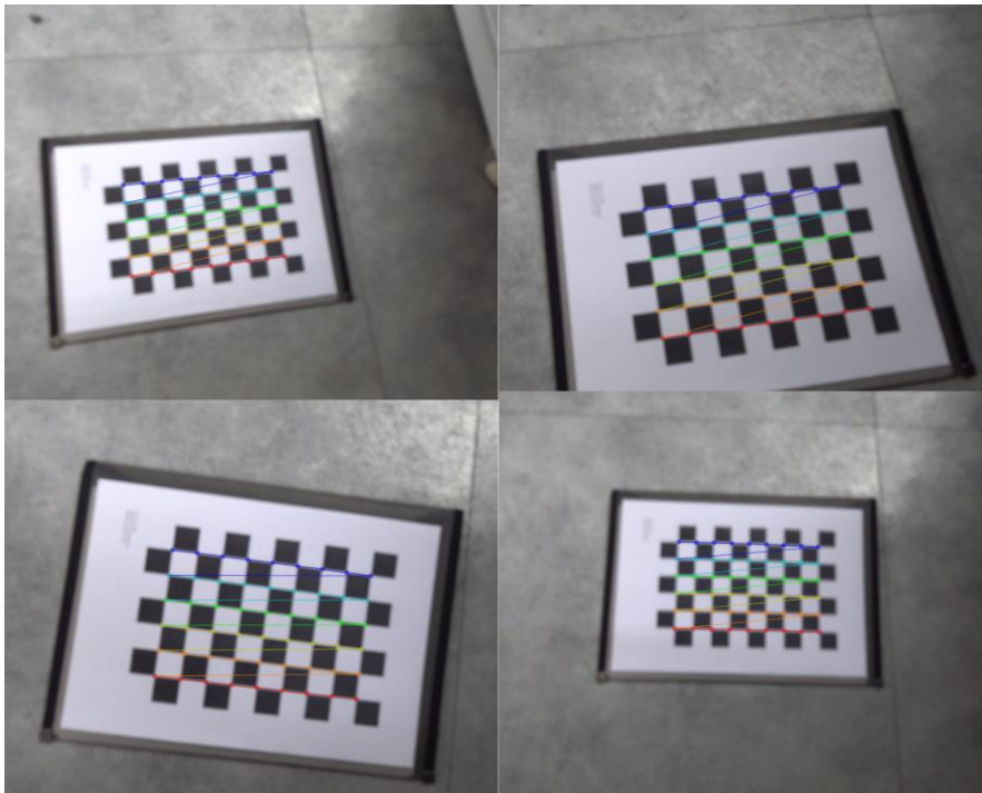
Figura 5-5. Ejemplo de las imágenes tomadas para la calibración
