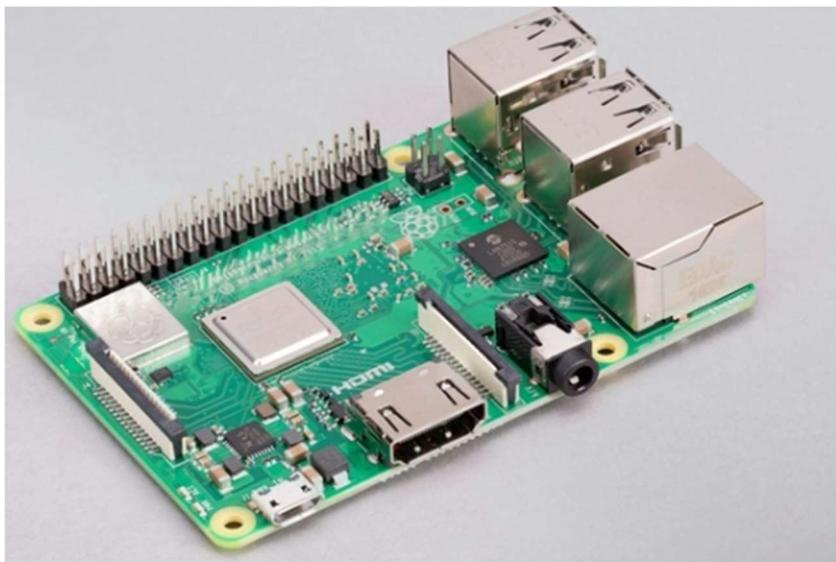
Figura 4-1. Raspberry Pi 3 Modelo B
