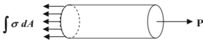
Figura 5.- Esquema de fuerzas al que se ve sometido la probeta en un ensayo de tracción [4].
