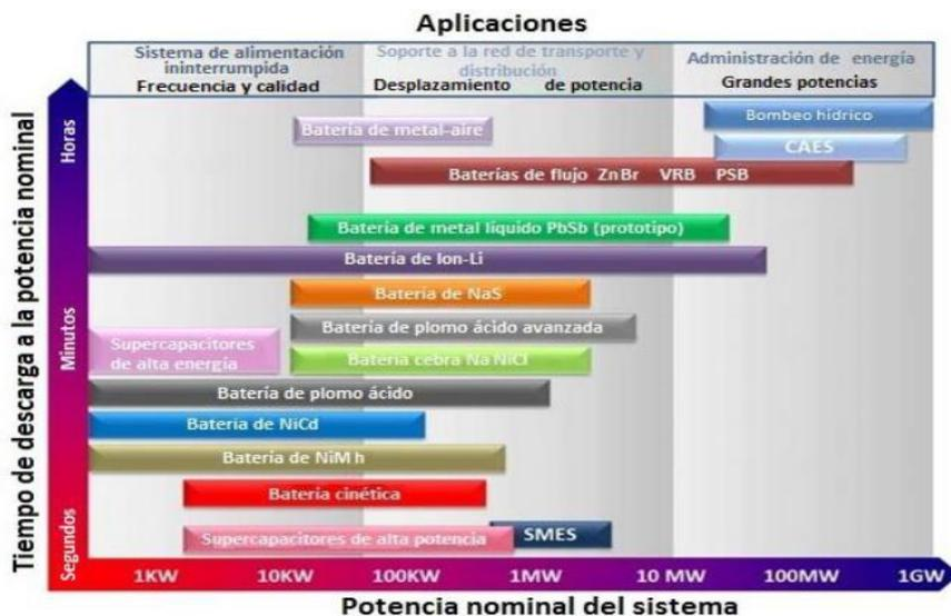
Fig 6 : Baterías según su aplicación, potencia y tiempo de descarga
