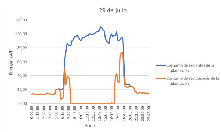
Fig 24 : Energía proveniente de la red antes y después de una implantación de 1.000 kWp.
