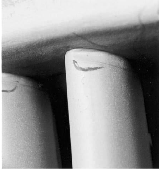
Figura 4-8. Material desprendido del borde de ataque de una fila de álabes estacionarios por erosión de partículas sólidas.
