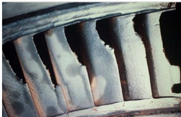
Figura 2-3. Daños provocados por partículas sólidas en las toberas de una etapa de control de turbina de vapor.
