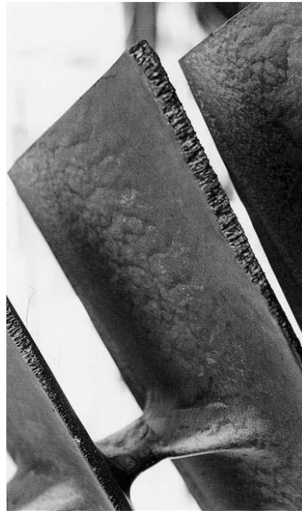
Figura 6-1. Erosión por impacto de la humedad en el borde de ataque de álabes.
