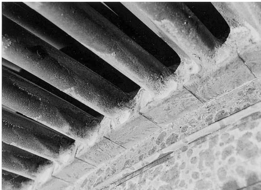
Figura 5-3. El resultado de una entrada de una cantidad considerable de agua de mar en el condensador, y la deposición de sal (NaCl) en una hilera de álabes giratorios.
