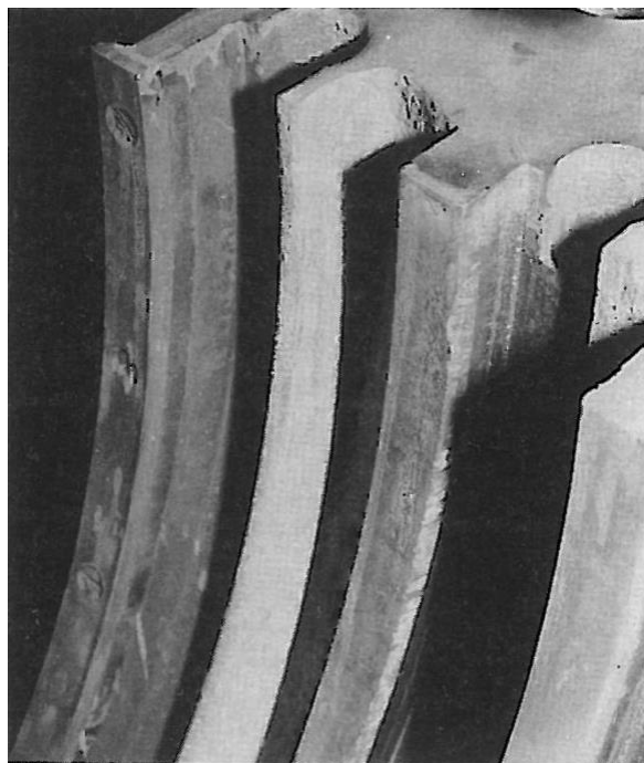
Figura 6-25. Erosión por estrangulamiento en la superficie de los sellos de vapor.
