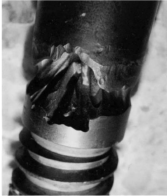
Figura 4-1. Vástago de una válvula de corte que ha sido sometido a la erosión de partículas sólidas.
