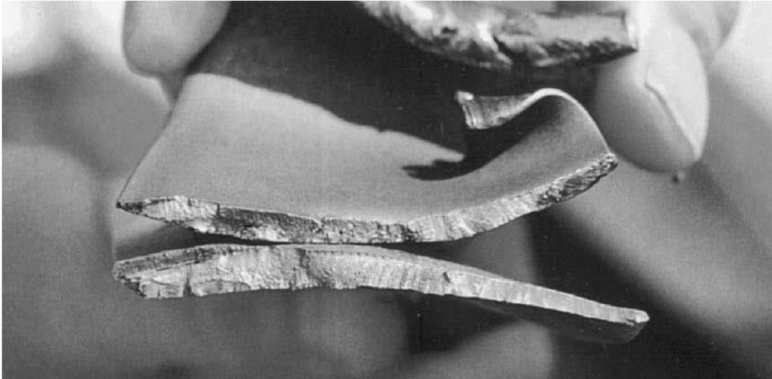
Figura 3-1. Las estrías o marcas de playa en la paleta de una pala L-1
