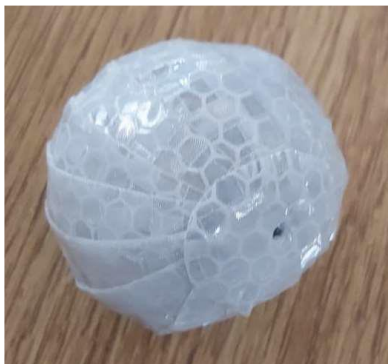
Figura 3-4. Marcador recubierto con material retrorreflectante.
