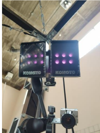
Figura 3-2. Cámara y foco infrarrojo empleados.
