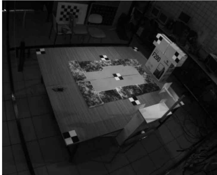
Figura 5-4. Marcadores para calibración PnP. Cámara 3.
