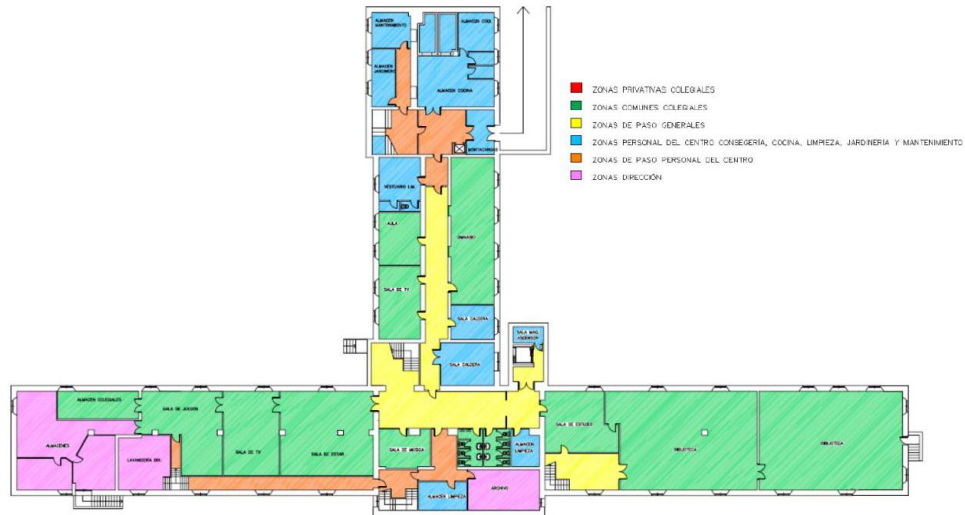
Imagen5.Plano de Usos Planta Sótano del colegio mayor Hernando Colón. Fuente: Archivo C.M.H.C.
