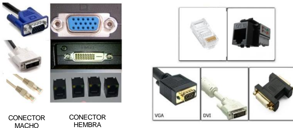
Figura 4-2. Especificaciones sobre los conectores a identificar.
