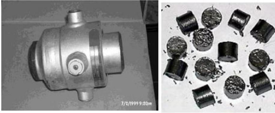
**ILUSTRACIÓN 3. JUNTA ROTATIVA (IZQUIERDA) Y GRAFITO LUBRICANTE (DERECHA) [3]**
