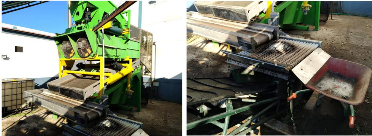
Figura 3-22. A izquierda conjunto Sopladora-Despalilladora I, a derecha imagen ampliada del Despalillado I.
