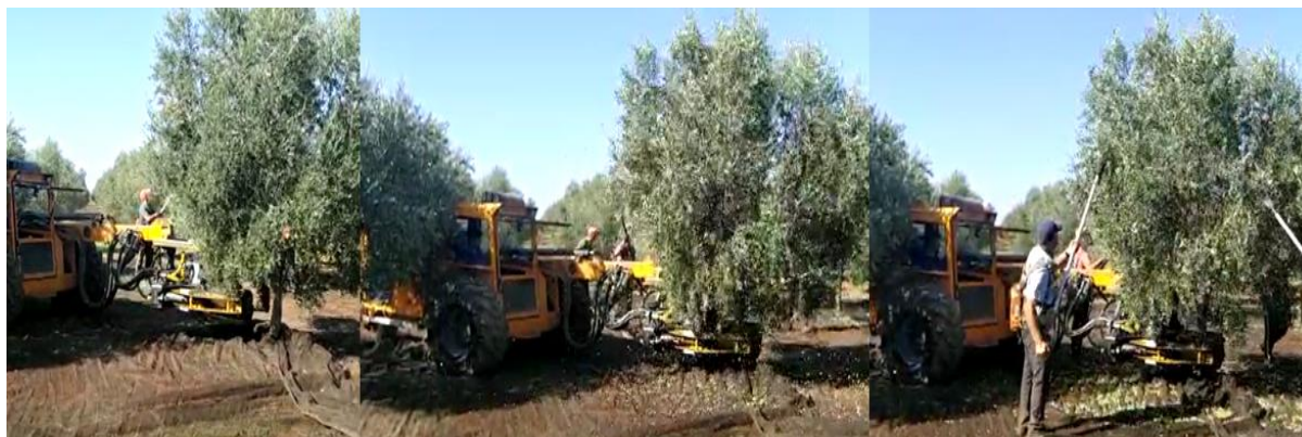
Figura 3-16. Secuencia de imágenes de la recolección de aceitunas con buggy y peines vibratorios.
