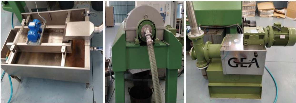
Figura 3-27. Centrifugación Horizontal. De izquierda a derecha decantación y salida del aceite, centrifugadora y salida del orujo.
