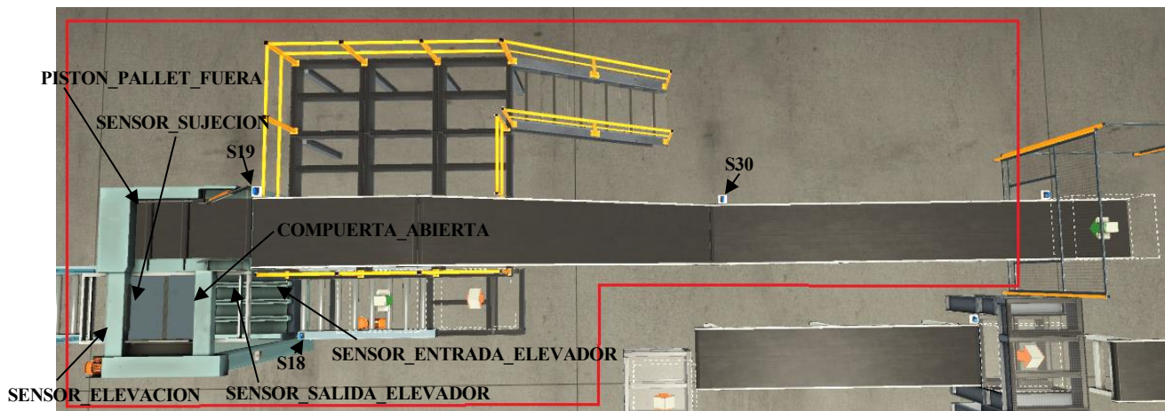
Figura 3-26: Ubicación en planta de los sensores de la estación de paletizado.
