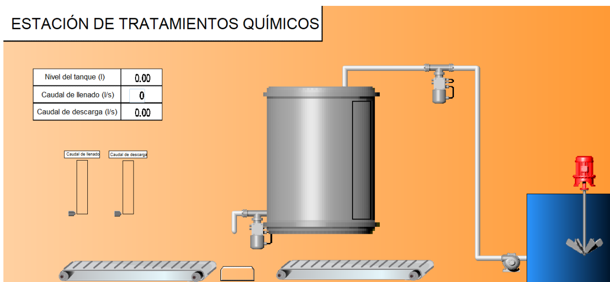
Figura 5-2: Pantalla gráfica de la estación de tratamiento químico (SCADA)
