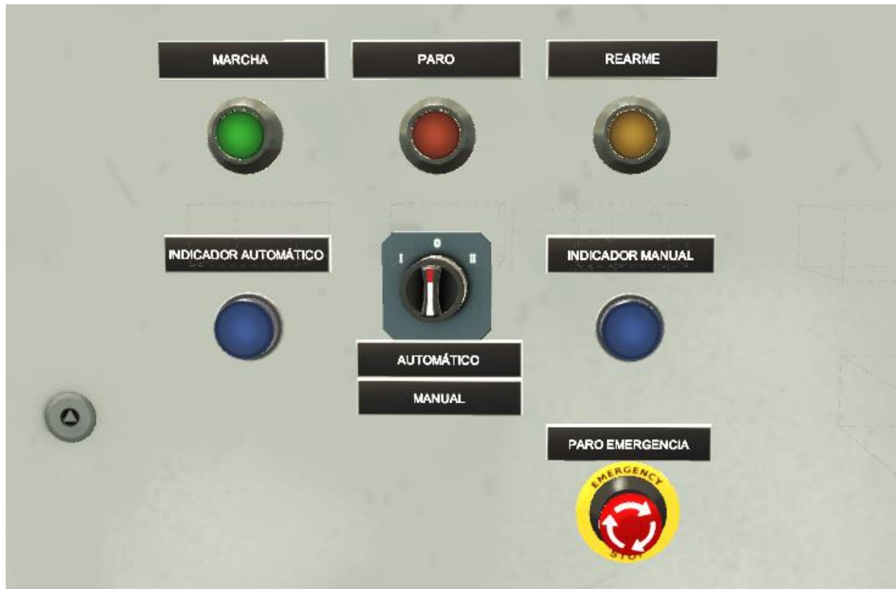
Figura 3-31: Operadores y señales del cuadro HMI de la planta
