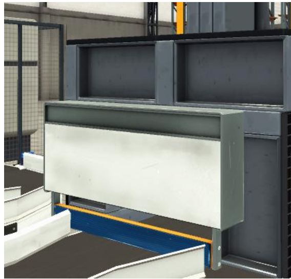
Figura 3-9: Barrera de parada al comienzo de la zona de chorreado de químicos.
