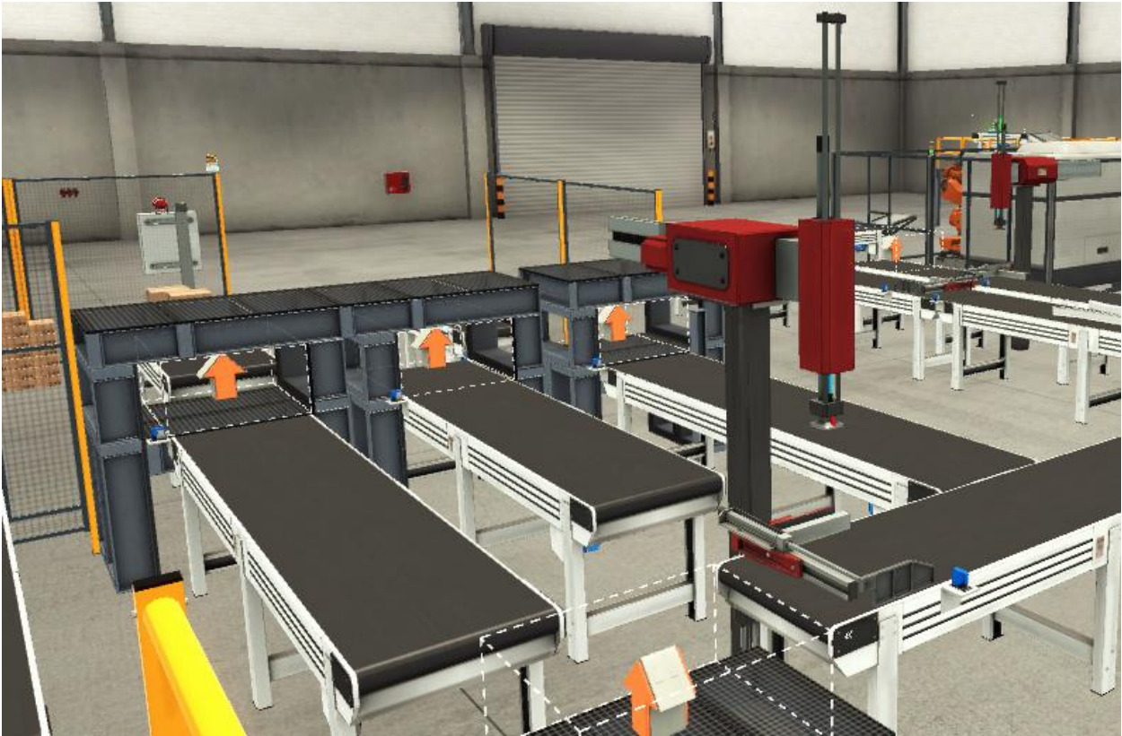
Figura 3-11: Visión general de la estación clasificadora de piezas terminadas.
