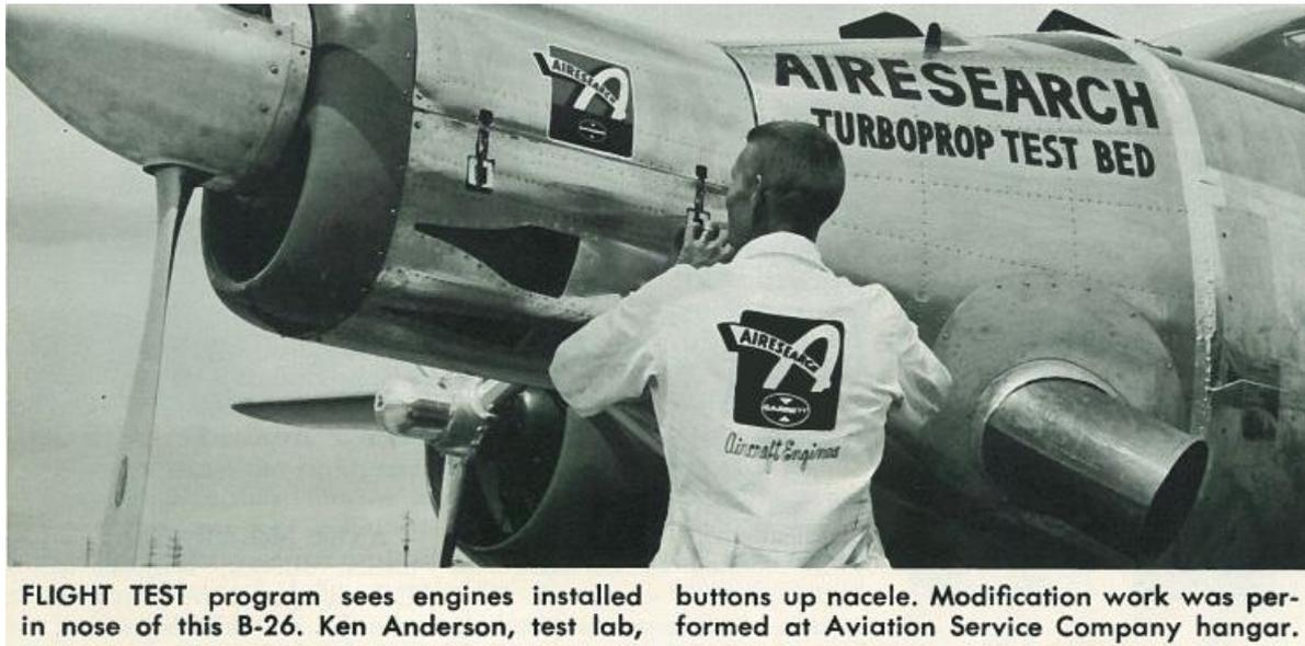
Figura 2-1. Instalación para pruebas del TPE 331 [8].
