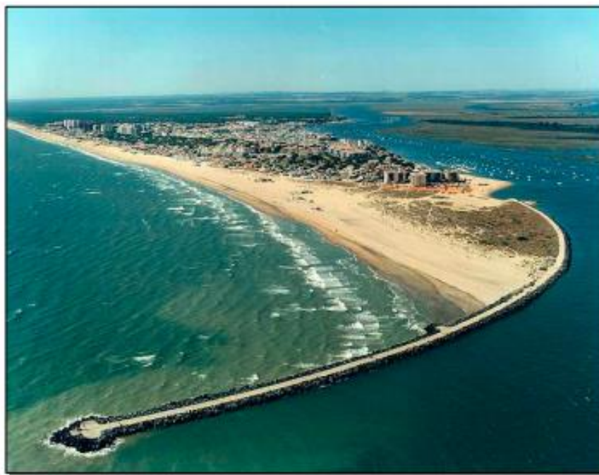
Fig. 12. Panorámica de Punta Umbría donde se observa la acumulación de arena en la cara oeste del espigón. Fuente: El litoral de Huelva: fisiografía y dinámica (Morales Gonzalez J.A, Borrego Flores J. 2008)
