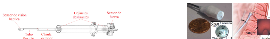
Figura 2.6 Catéter autónomo desarrollado por [4], a la izquierda el esquema de la estructura completa, a la derecha la punta del catéter. .
