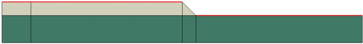
Figura 3-39. Parte inferior del modelo con la superficie esclava del pegado marcada
