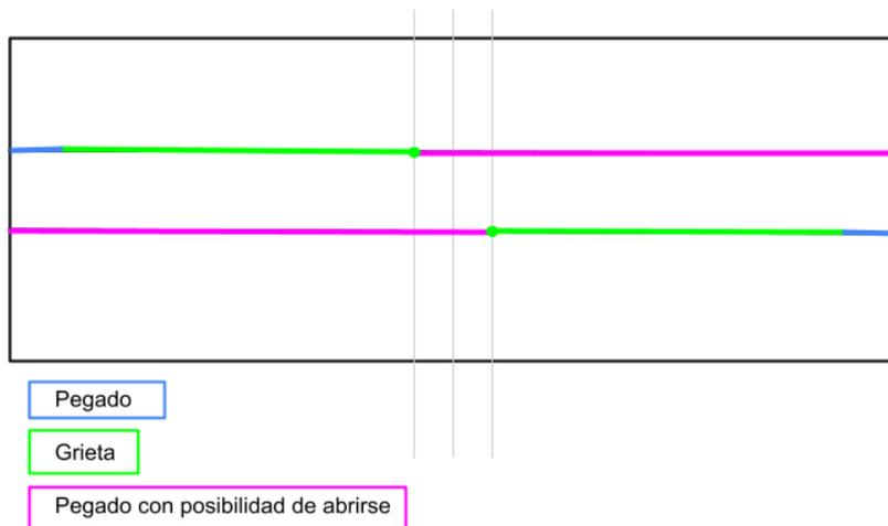
Figura 3-55. Esquema del modelo con dos delaminaciones con representación de los diferentes tipos de interacciones
