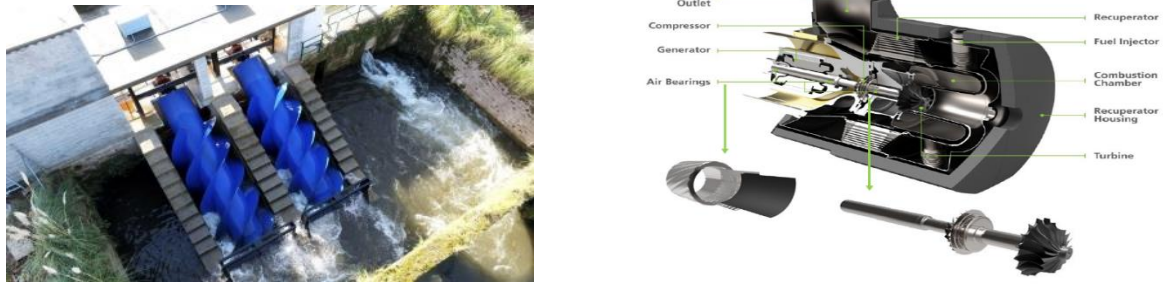
Figura 3.4: A la izquierda una microhidráulica y a la derecha el interior de una microturbina de gas. Fuente: Iberdrola.
