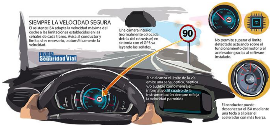
Figura 3. Funcionamiento del sistema ISA (Asistente de velocidad inteligente).
