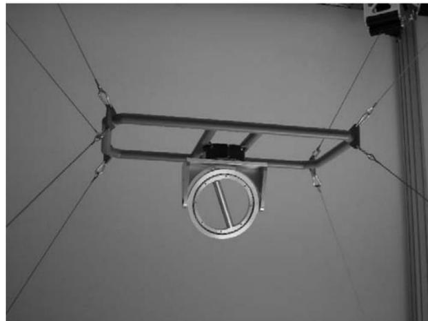
Figura 1-16: Efector final del robot MACARM. Fuente:[23]
