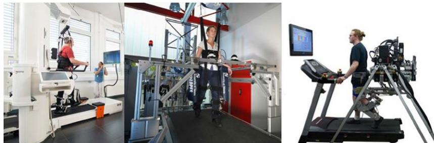
Figura 1-1: Exoesqueletos de rehabilitación de miembros inferiores. Fuente: [12]
