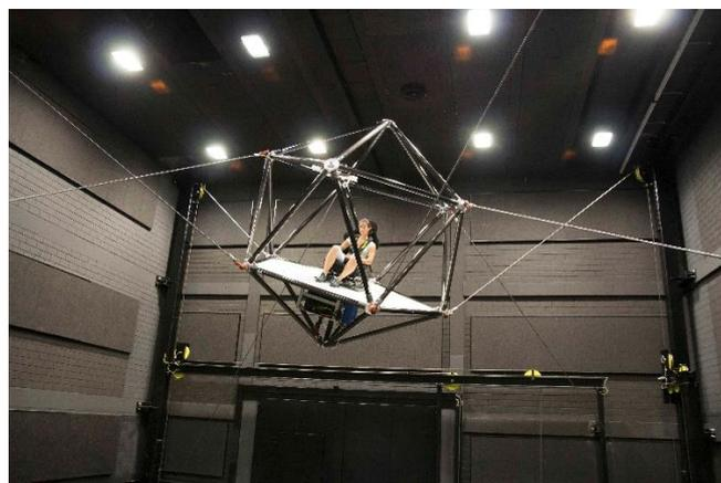
Figura 1-9: Cablerobot Simulator en funcionamiento. Fuente:[20]
