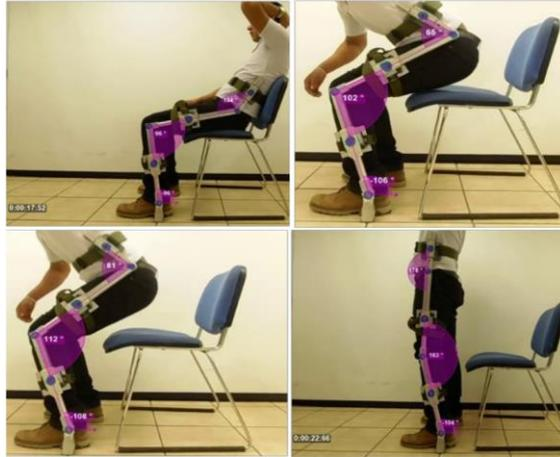
Figura 3-36: Etapas en la transición de sentado a levantarse. Fuente [35]
