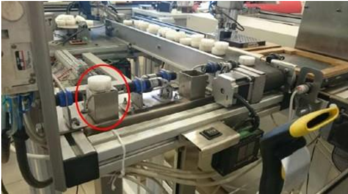
Figura 27: Almacenamiento y extracción de piezas del alimentador de piezas
