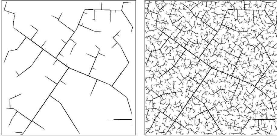
Figura 2.6: Ejemplo de exploración por el algoritmo RRT. A la izquierda, después de 45 iteraciones. A la derecha, 2345 iteraciones. Puede verse como el RRT alcanza rápidamente las zonas inexploradas [2]
