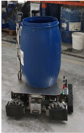
Figura 4.8: Plataforma robótica final utilizada para el transporte de materiales durante el proceso de producción de pinturas en Tintas Robbialac S.A. Debajo de la superficie metálica plana tiene una báscula que permite controlar la carga que lleva y adaptar el movimiento a esta.
