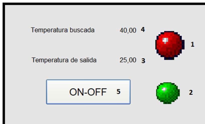
Figura 5.16: Pantalla de supervisión del sistema
