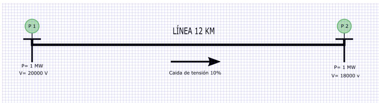
**Figura 1.5** Caída de tensión en una línea de 12 km
