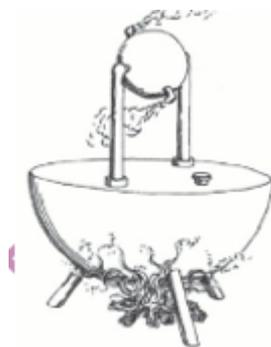
**Figura 1.1** Eolipila, máquina utilizada por Herón.
