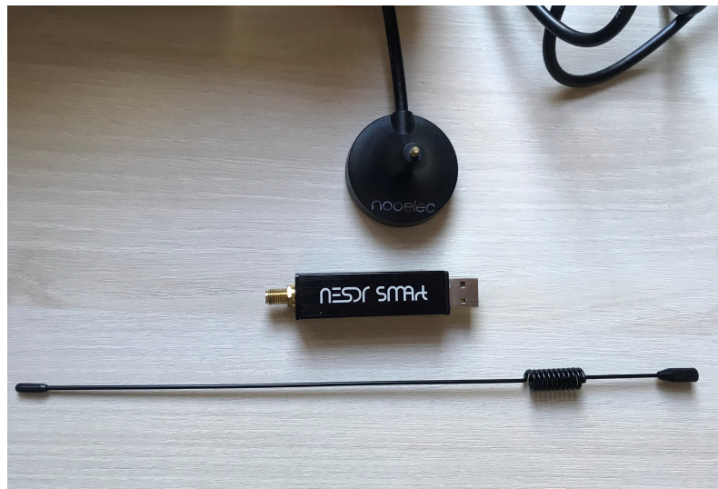
Figura 3.2 RTL-SDR empleado en este proyecto.
