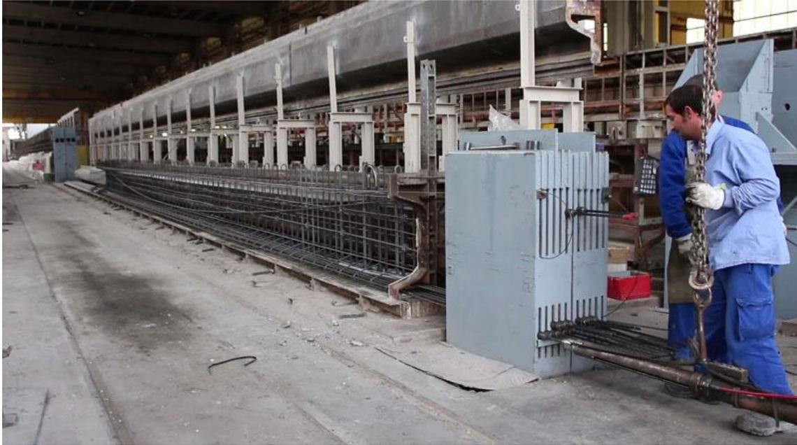
Figura 2-2. Proceso de pretensado con armadura pretesa [10].
