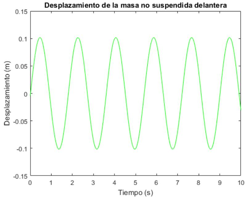
Figura 3-5: Desplazamiento de la masa no suspendida del eje delantero frente a una onda sinusoidal
