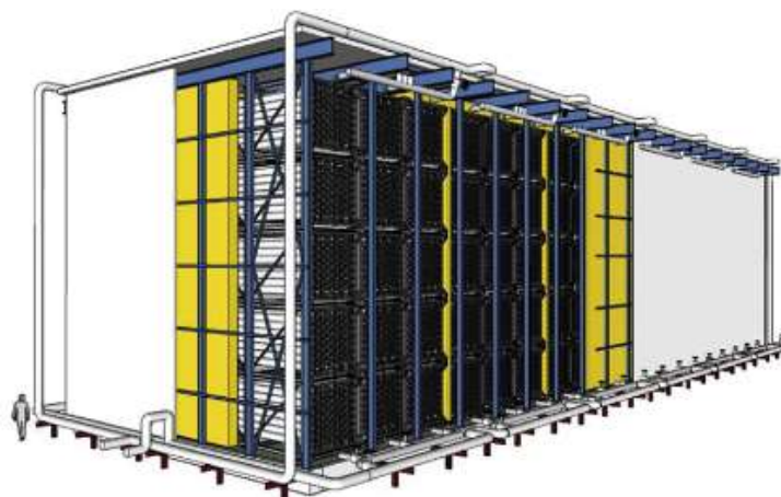
Figura 47: Sistema de almacenamiento de 280 MWh compuesto de módulos de hormigón aislados [92]
