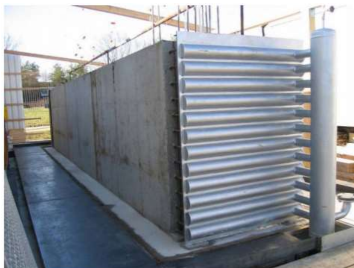
Figura 48: Prototipo de módulo (sin aislamiento) desarrollado por Laing et al. [93]
