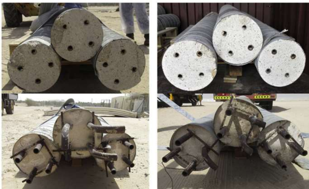
Figura 51: Elementos de hormigón extraídos de la batería térmica al final de la experiencia sin mostrar roturas o degradación [92]
