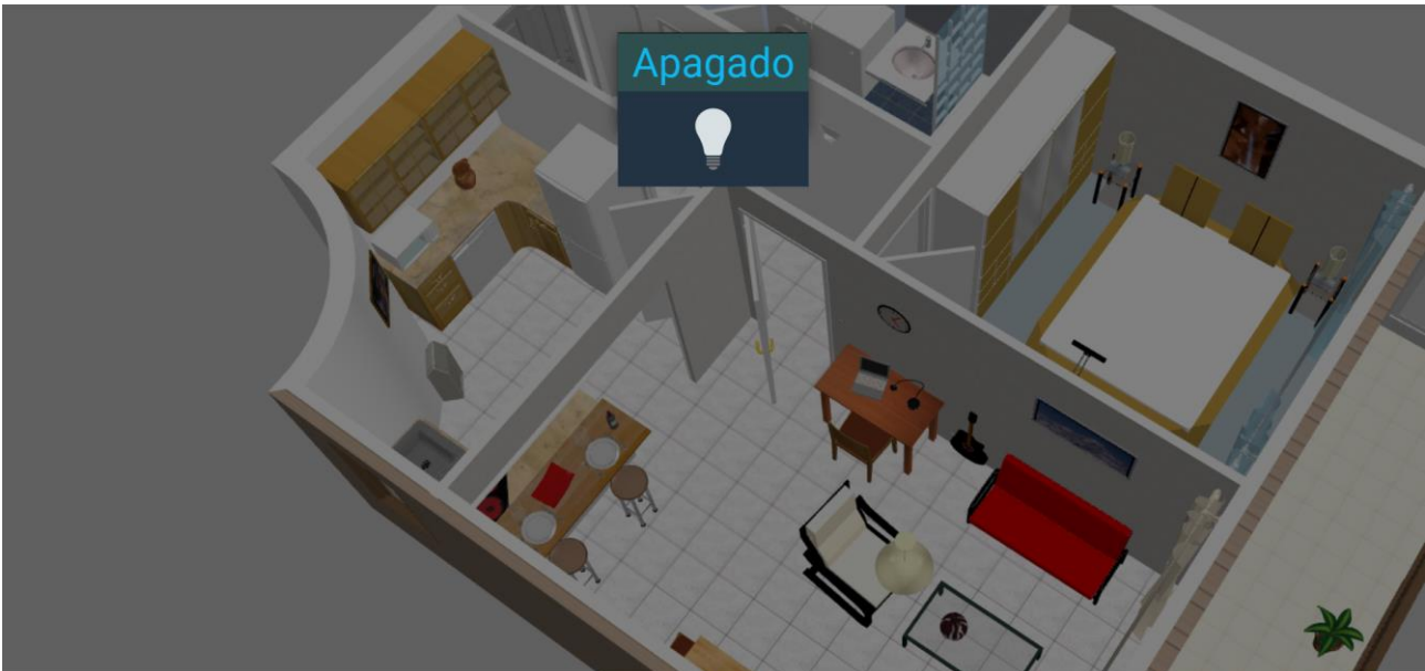
Ilustración 59. Visualización del control de la luminaria
