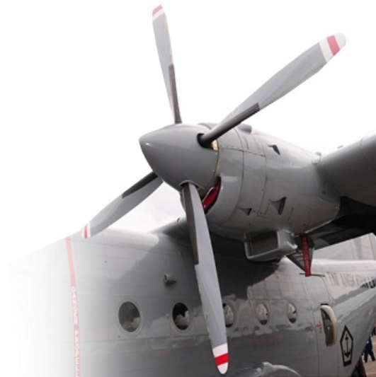
Figura 2.3 Hélice Dowty Rotol R-334/4-82-F/13 [9].
