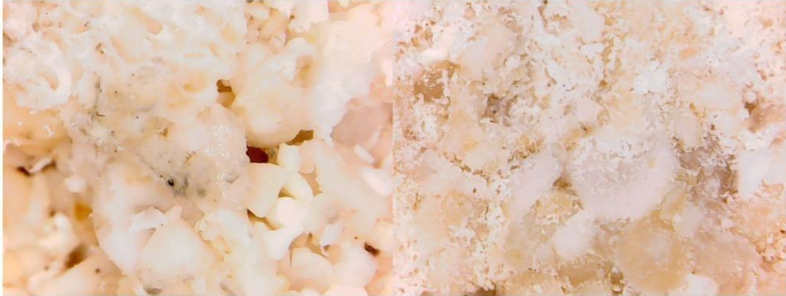
Ilustración 28: Muestra de los efectos del tratamiento Myxostone M3P sobre calcarenita bioclástica de un pilar de la fuente del Palacio de Carlos V en la Alhambra de Granada. Lupa de 800 aumentos (KBYOBIOLOGICAL, 2021).
