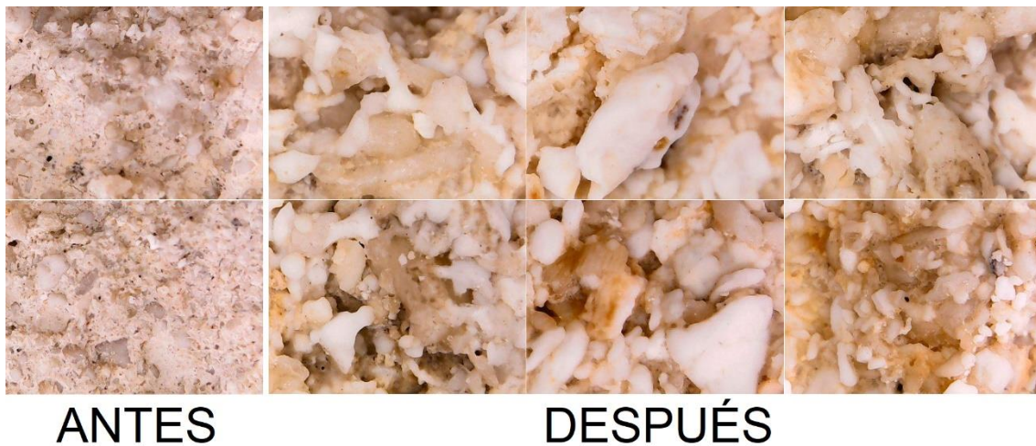
Ilustración 27: Muestra de los efectos del tratamiento Myxostone M3P sobre calcarenita bioclástica de un pilar de la fuente del Palacio de Carlos V en la Alhambra de Granada. Lupa de 800 aumentos (KBYOBIOLOGICAL, 2021).
