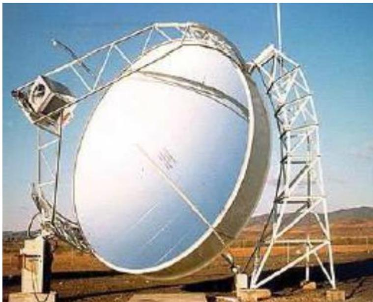
Ilustración 7: Captador Disco Stirling. [17]
