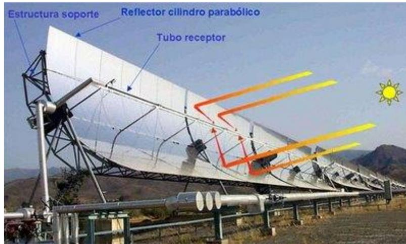
Ilustración 4: Elementos de un módulo cilindro-parabólico. [14]
