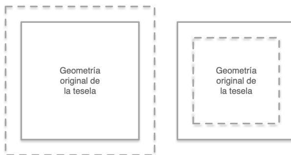
Figura III.6.4: Offset positivo (izquierda) y negativo (derecha) de una tesela. En trazo continuo se representa la geometría original de la misma, mientras que el trazo discontinuo es la geometría modificada por el offset .
