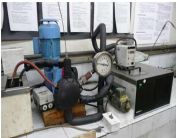
Figura 2 - 4 a) Esquema de funcionamiento y b) equipo utilizado para el secado supercrítico. Tomado de Briceño [51].
