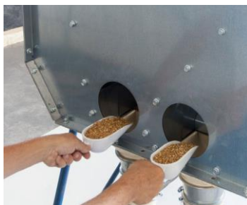
Figura 11. Toma de muestras del cilindro alveolado
