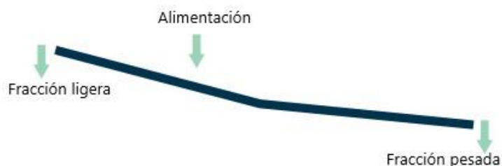
Figura 13. Separación de la alimentación en la limpieza
