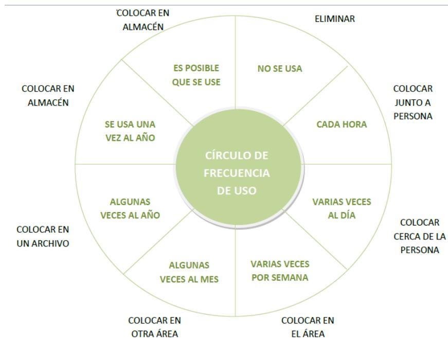
Figura 2-5: Esquema de implantación de 'Seiton' (Fuente: [3])
