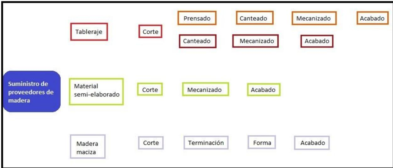
Figura 4-7: Esquema de línea del producto
