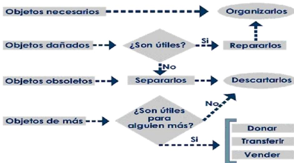
Figura 2-3: Esquema de implantación de 'Seiri' (Fuente: [2])
