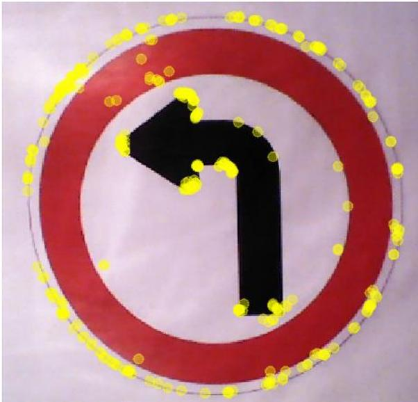
Figura 7-3 Puntos clave señal giro izquierda
