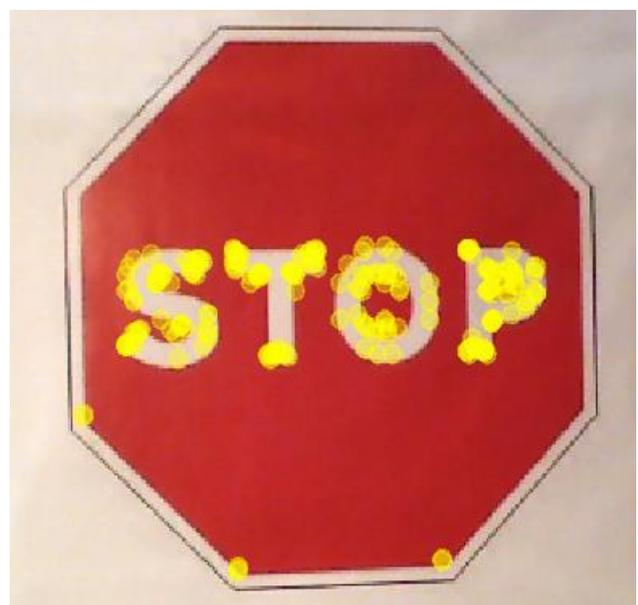
Figura 7-2 Puntos clave señal de STOP
