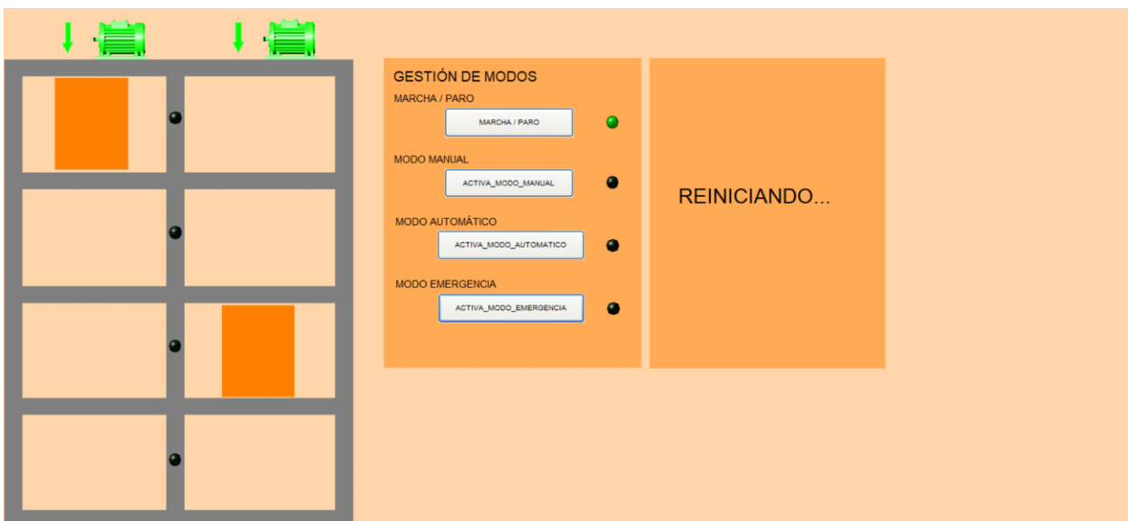
Figura 8.3 SCADA Modo Reinicio
