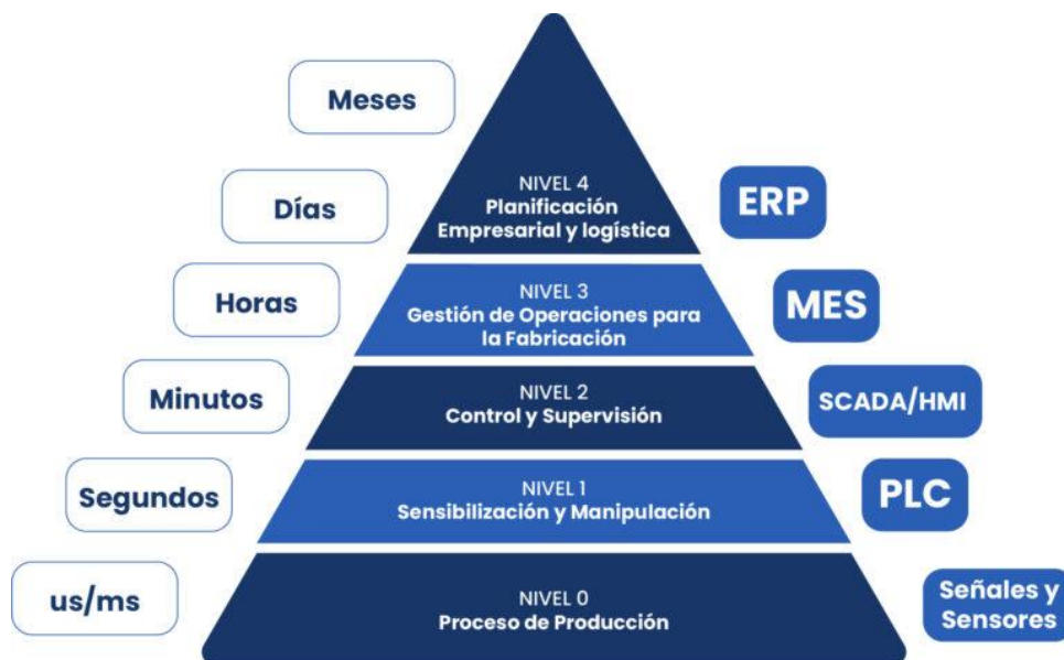
Figura 1.1 Pirámide de la automatización
