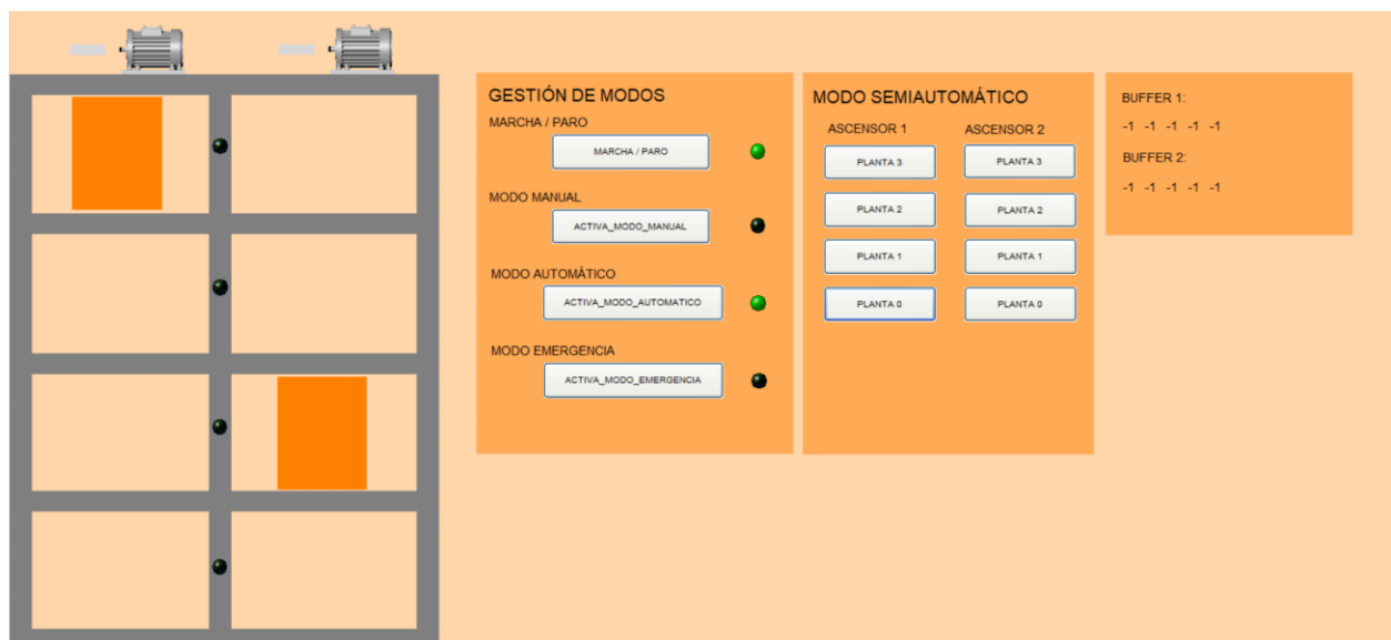
Figura 8.1 SCADA Modo automático
