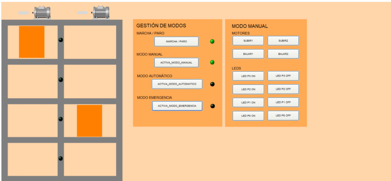
Figura 8.2 SCADA Modo manual
