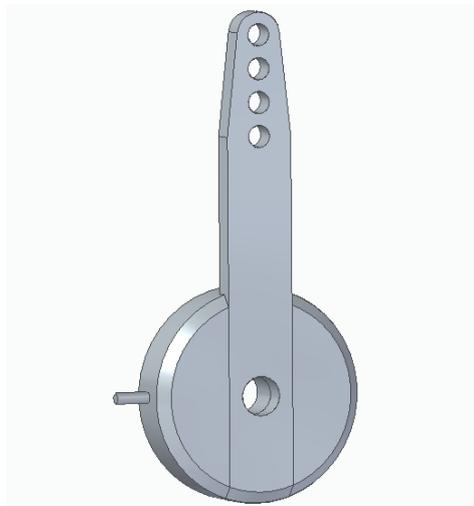
**Ilustración 84:** Conjunto Puerto de control de arranque y parada
