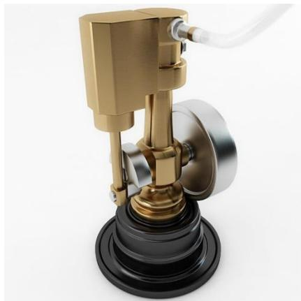
*Ilustración 116: Maqueta motor de vapor oscilante [51]*
