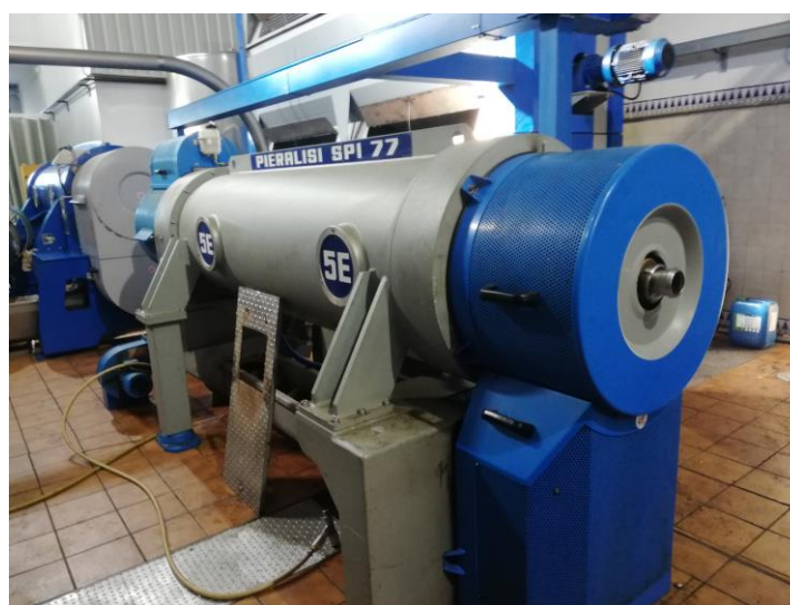
Figura 5.10 Decánter horizontal de dos fases.
